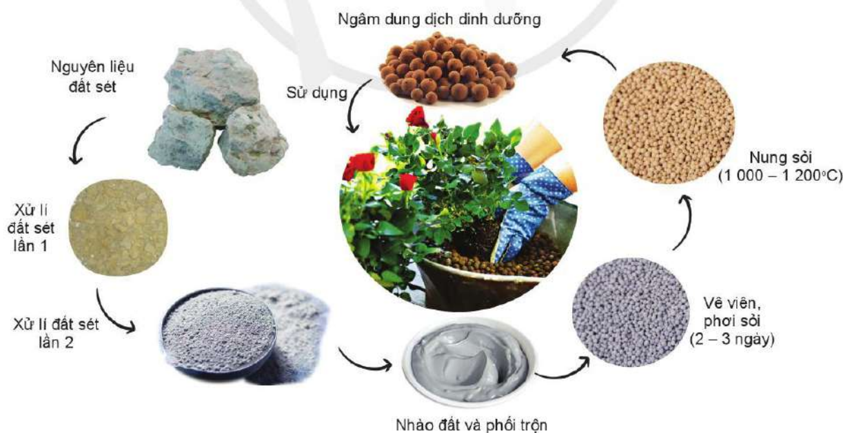
Hình 6.5. Quy trình sản xuất sỏi nhẹ Keramzit
